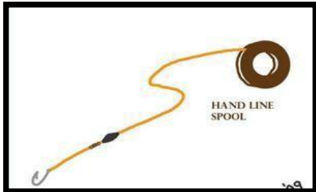
Gambar 1. Konstruksi Pancing Ulur Sumber : Pusat Penyuluhan Kelautan dan Perikanan, 2011.
