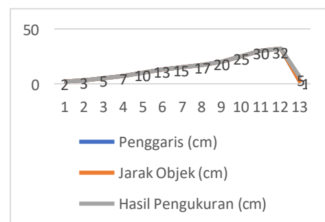
Gambar 8. Grafik Perbandingan Sensor HC-SR04 dengan Penggaris
