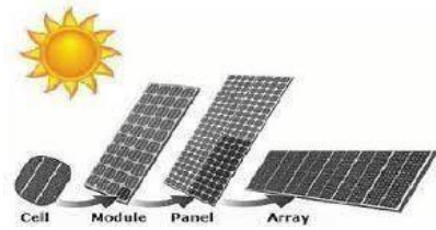
Gambar 2. Susunan dari solar cell pada modul surya
