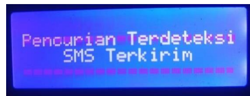
Gambar 18. Pengujian kehilangan kendaraan
