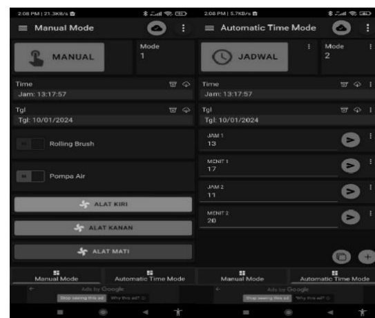
Gambar 7. Opsi Kendali Manual dan Otomatis Pada Aplikasi “IoT MQTT Panel”
