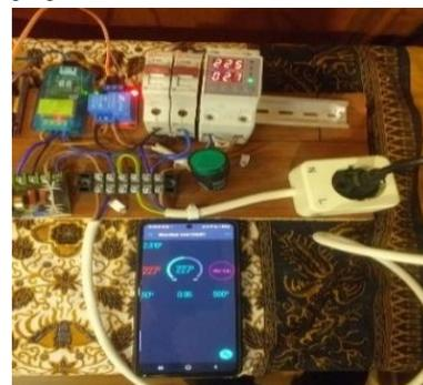
Gambar 9. Simulasi nilai tegangan OVR dengan Blynk
