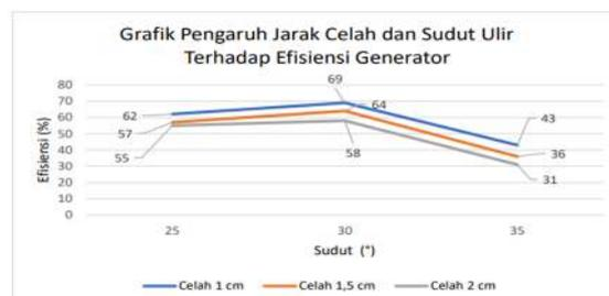
Gambar 5. Grafik dampak variasi terhadap efisiensi generator Berdasarkan analisis grafik di atas, dapat disimpulkan bahwa sudut ulir 30° dengan jarak celah 1 cm memberikan efisiensi generator tertinggi. Ini disebabkan oleh aliran air yang secara maksimal mengenai ulir turbin, sehingga meningkatkan gaya dorong air pada turbin dan mempercepat putaran. Semakin tinggi putaran yang tercapai, semakin besar dampaknya terhadap peningkatan daya output generator.
