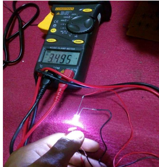
Gambar 4.1 Pengujian LDR diberi cahaya tanpa penghalang.
