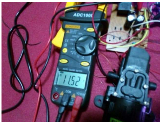
Gambar 4.3 Tegangan masukan dari Mikrokontroler pada saat logika “1”
