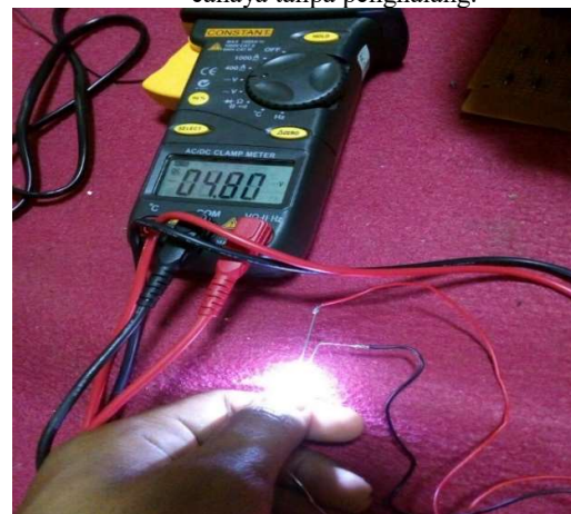
Gambar 4.2 Pengujian LDR diberi cahaya dengan penghalang.
