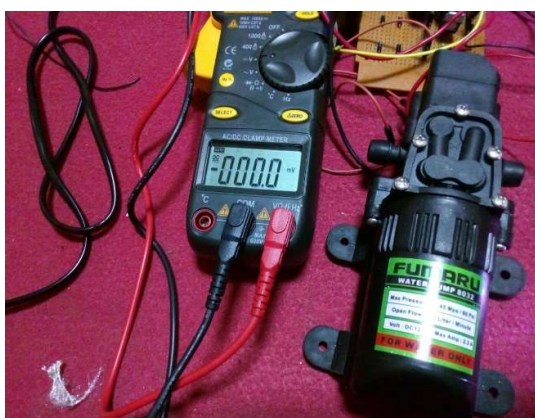
Gambar 4.4 Tegangan masukan dari Mikrokontroler pada saat logika “0”
