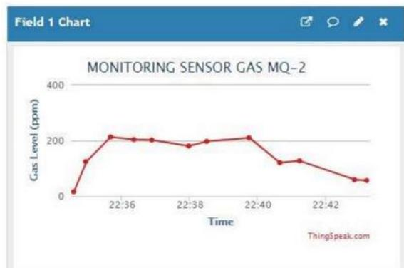
Gambar 3. Grafik IoT Platform untuk Sensor MQ-2
