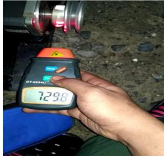
Gambar 8. Pengujian blok putaran mekanik
