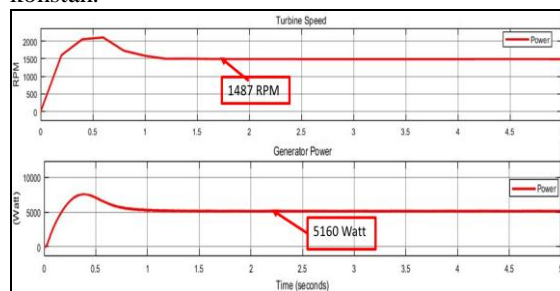
Gambar 10 Hasil Simulasi Kecepatan Putar Turbin dan Daya Generator Skenario Pertama
