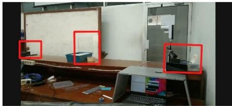
Gambar 6. jarak 2 meter antar alat dengan penghalang kaca.
