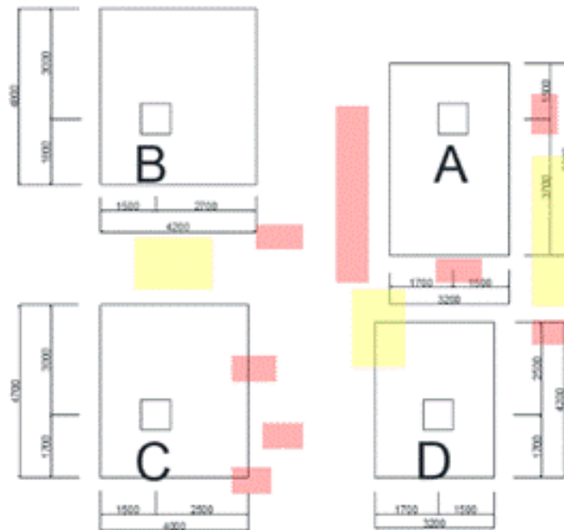
Gambar 3.3 Dimensi Pondasi Hasil Interpretasi Radiogram Scan Pedestal A ke Pedestal D dan Indikasi Adanya Kantung Air
