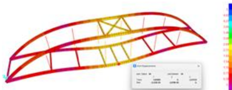
Gambar 16 Deflection akibat Kombinasi Beban pada Model Jembatan Bentuk Lengkung Lingkaran
