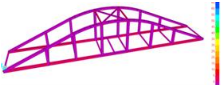
Gambar 20 Stress Diagram akibat Kombinasi Beban pada Model Jembatan Bentuk Lengkung Parabola
