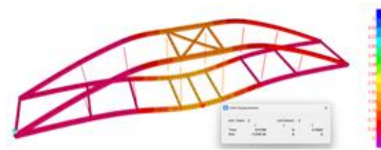
Gambar 21 Deflection akibat Kombinasi Beban pada Model Jembatan Bentuk Lengkung Parabola
