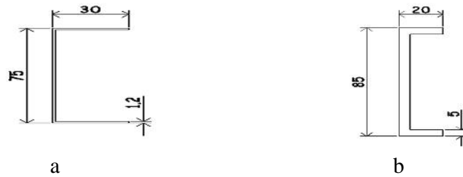
Gambar 4. Penampang profile atap (a) dan kolom (b)
