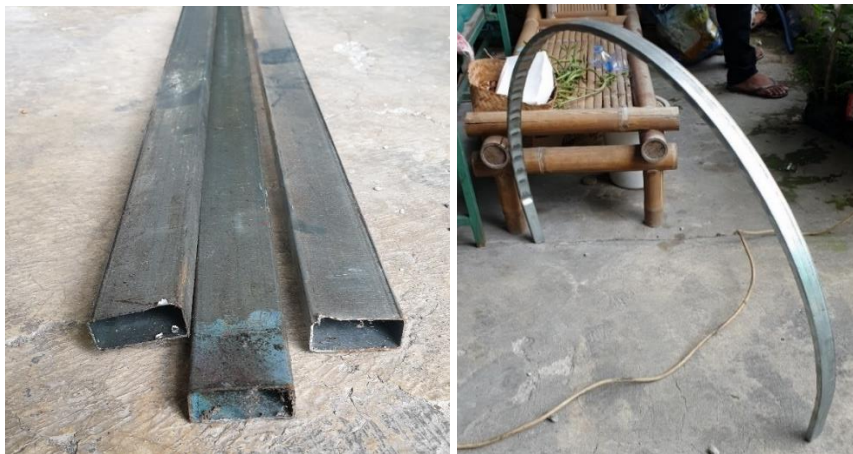
Gambar 3. Pipa hollow sebelum dan setelah di bending
