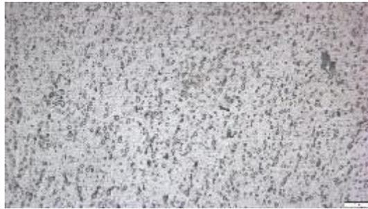
Gambar 9 Struktur mikro daerah logam las menggunakan *filler metal* ER 5183
