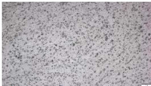
Gambar 7 Struktur mikro daerah logam las menggunakan *filler metal* ER 5556
