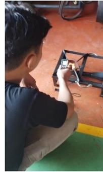
Setelah proses pengujian selesai, dilanjutkan dengan pengumpulan hasil temperatur dari setiap *burner* yang digunakan ditunjukkan pada Tabel 2. Setiap *burner* menghasilkan suhu yang berbeda-beda, yang nantinya akan dianalisis lebih lanjut untuk menentukan efisiensi dan performa masing-masing.
