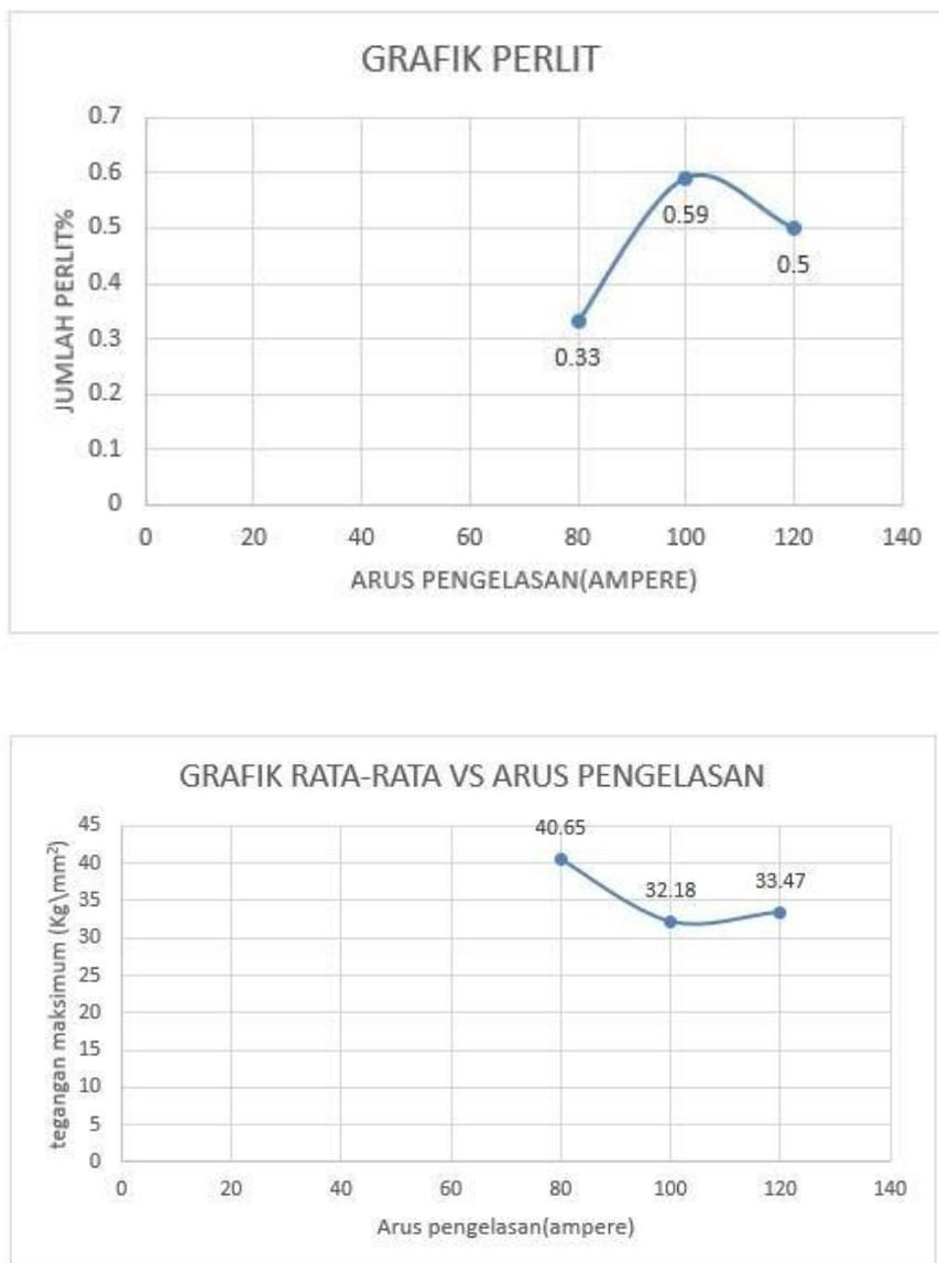
Gambar 4. 4 TEGANGAN RATA RATA 80A VS ARUS
