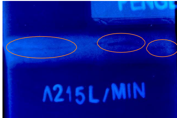
Gambar 5 Spesimen Uji A2 Radiography Test (Aliran gas 15 L/min dan temperatur pendingin air 5°C - 8°C)
