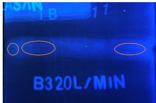
Gambar 7 Spesimen Uji B3 Radiography Test (Aliran gas 20 L/min dan temperatur pendingin air 25°C - 28°C)
