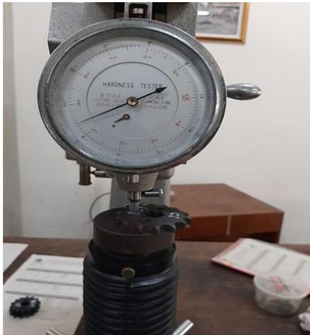
Gambar 8. Pengujian kekerasan *Rockwell*
