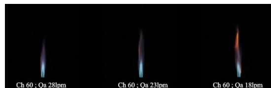
Gambar 4. 2 Foto api Inverse Diffusion Flame dengan tekanan bahan bakar 0,75 bar, chamfer 40°, tekanan udara 5,5 bar
