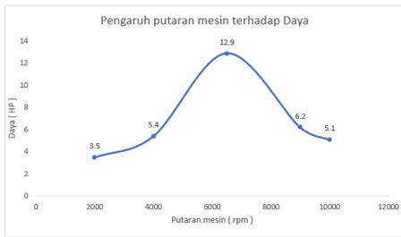
Gambar 4.1. Pengaruh putaran mesin terhadap daya yang dihasilkan dengan viskositas konstan.
