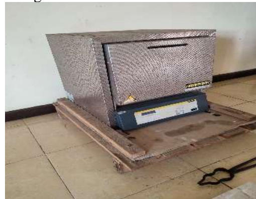
Furnace untuk preheating
