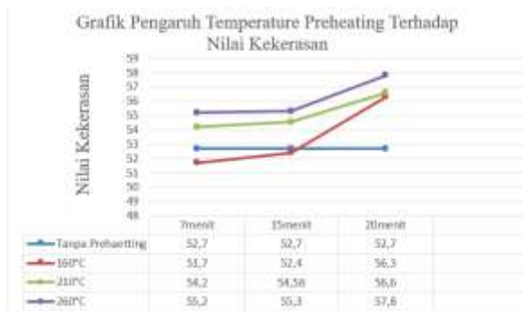
Grafik pengaruh Temperature Preheating Terhadap Nilai Kekerasan
