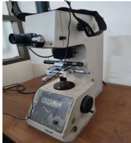
Mikroskop untuk melihat struktur mikro pada baja
