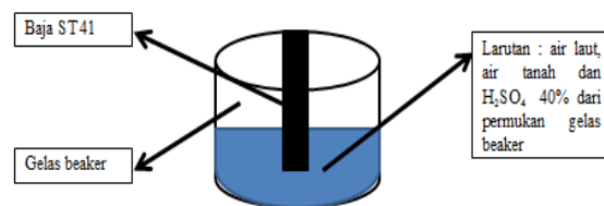
Gambar 3.2 gelas beaker yang sudah terdapat larutan pengujian dan baja ST 41
