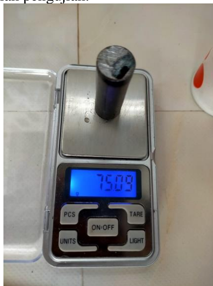
Gambar 14 pengukuran berat setelah pengujian akibat korosi
