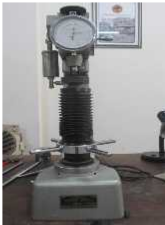
Gambar 3. Alat uji kekerasan Rockwell
