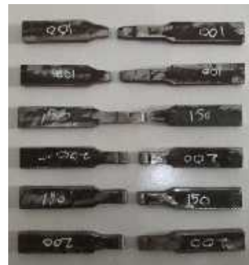
Gambar 6. Spesimen Uji Tarik
