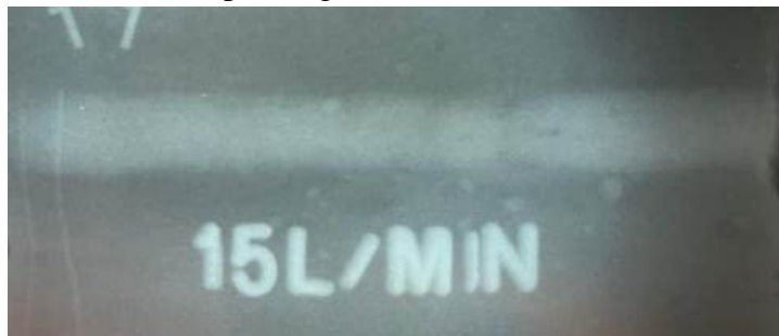
Gambar 6 Spesimen Uji B Radiography Test (Aliran gas 15 L/min dan tanpa pendinginan)
