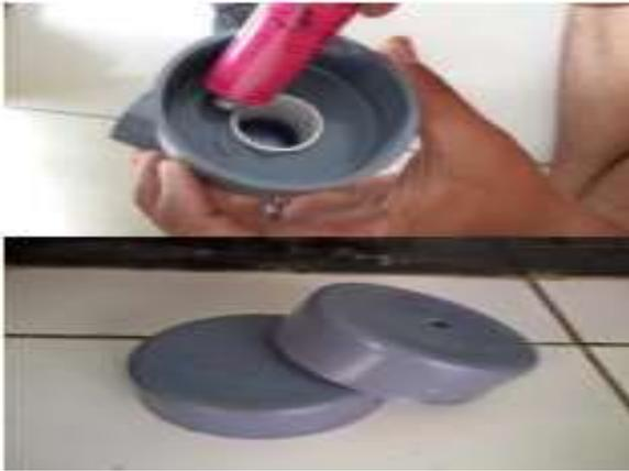
Pasang dop 3 dim pada masing-masing bagian bawah pipa 3 dim. Beri lem lubang kedua do 3 dim yang belum terpasang sebesar pipa 1/2 dim. Lalu pasang pipa 1/2 dim sepanjang 10 cm. Pastikan tidak ada yang bocor.
