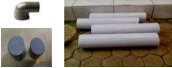
Buat 4 buah pipa 1/2 dim sepanjang 10 cm, rekatkan outlet dengan L dan pipa 10 cm yang telah dilubangi kecil-kecil, Lalu pasang dop 1/2 dim pada ujung pipa 1/2 dim. Setelah kuat pasang rangkaian tersebut pada pipa 3 dim yang lebih pendek. Pastikan terpasang dengan kuat, rapat, dan tambahkan lem.
