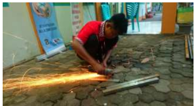
Gambar 1. Proses pemotongan bahan rangka neon box
