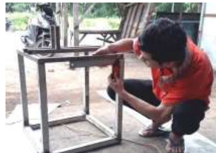
Gambar 1.2 Proses Pembuatan Kerangka Alat Mixer
