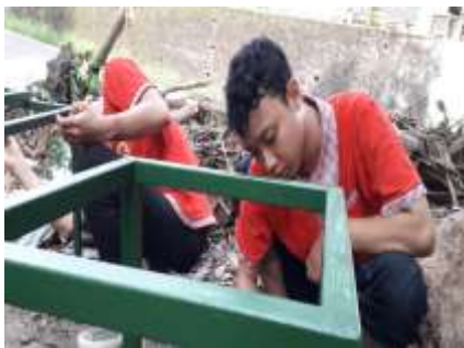
Gambar 1.5 Proses Pengecatan Kerangka Alat Mixer
