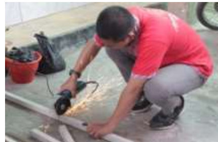
Gambar 1.1 Proses Pemotongan Kerangka Alat Mixer
