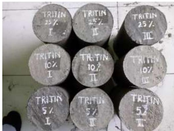
Gambar 2 Benda uji *permeabilitas* beton
