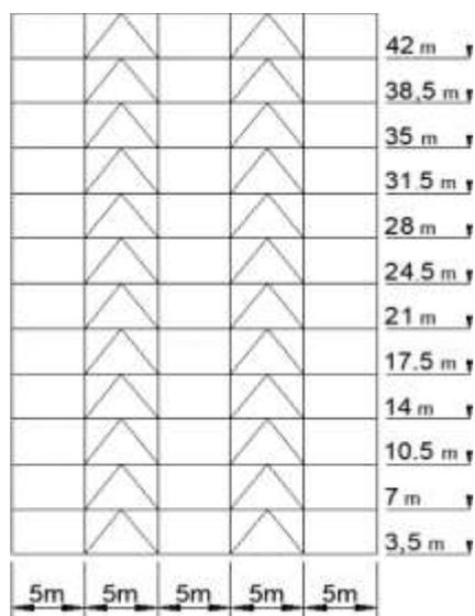
**Gambar 4** Tampak Samping Struktur Konsentrik 12 Tingkat.
