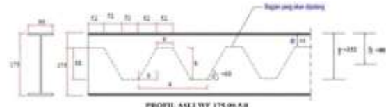
Gambar 4.1. Potongan profil IWF asli sebelum dijadikan kastela.
