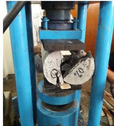
Gambar 2.6 Pengujian tes tarik belah beton
