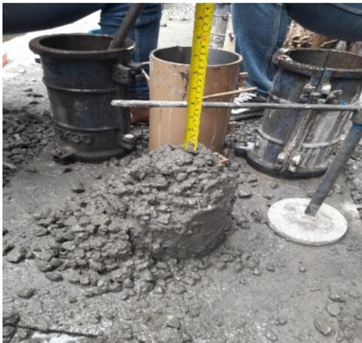
Gambar 2.4 Pengukuran nilai slump
