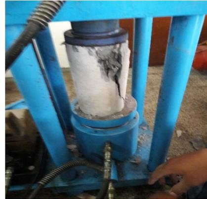
Gambar 2.5 Pengujian tes tekan beton
