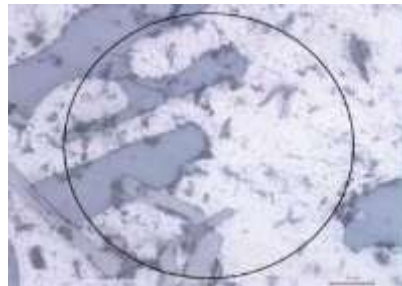
Gambar 5. Gambar Material Komposit Al-Abu dasar batubara dengan quench air garam, holding time 6 jam pembesaran 100x.
