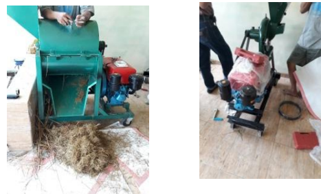
Gambar 4. Mesin Produksi Pakan Ternak Ruminansia
