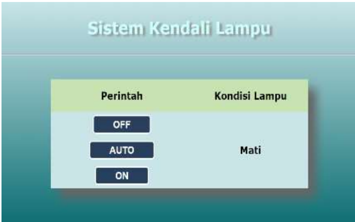
Gambar 3. Web Designer Sistem Lampu Otomatis menggunakan ESP 8266.
