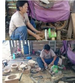
Gambar 3.3 Mitra latihan mengoperasikan alat mesin potong circular shaw dan mesin gerinda tangan
