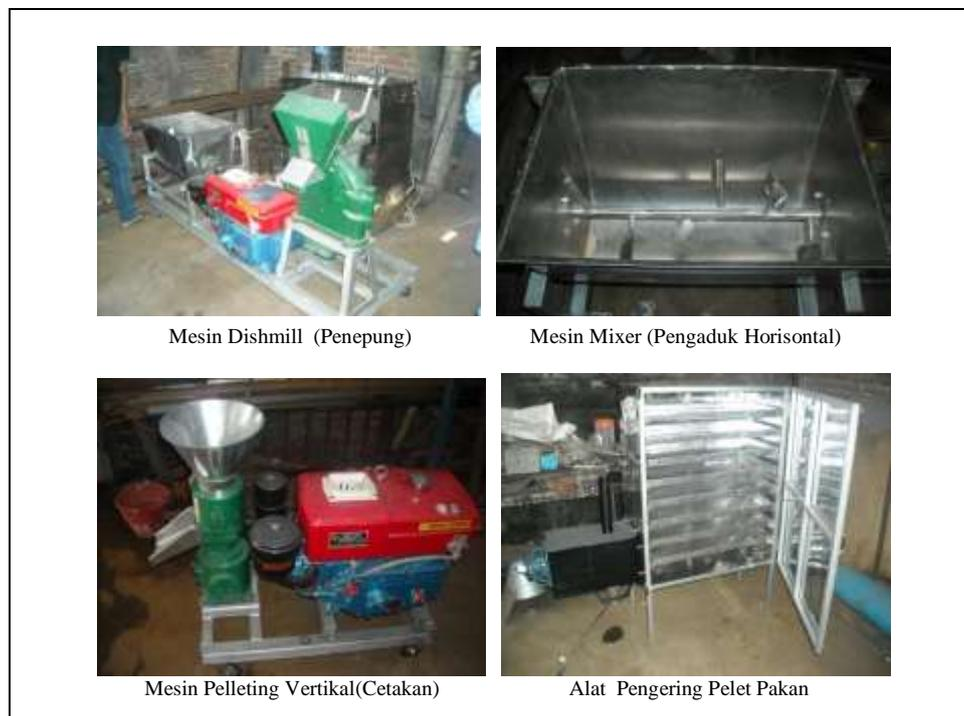
Gambar 2. Mesin Produksi Pakan Ternak
