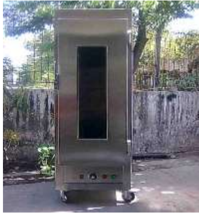
Proofer Bahan : Aluminium Ukuran Loyang: 60 x 40 Kapasitas : 6 loyang
