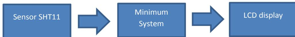
Gambar 4. Diagram Alir Kerja Alat THC
