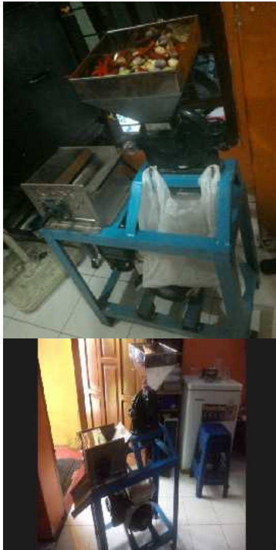
Gambar 2. Mesin untuk menghaluskan rempah-rempah (bumbu)
