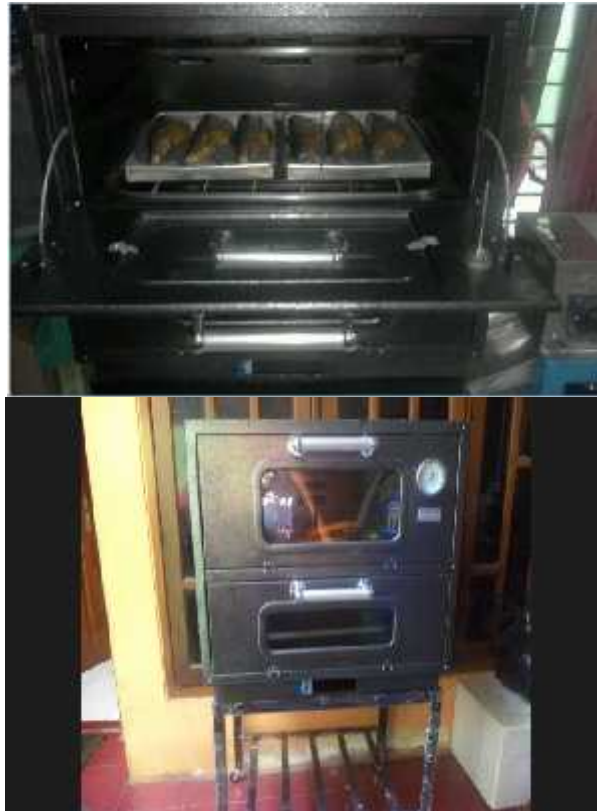
Gambar 3. Oven yang digunakan untuk mengurangi kadar air Otak-otak Bandeng sehingga produk dapat cepat digoreng serta tidak cepat basi
