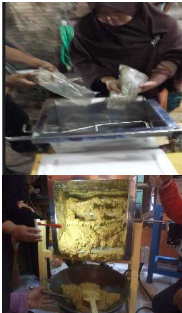
Gambar 1: Mesin untuk menghaluskan daging ikan bandeng dan mencampur daging ikan bandeng
