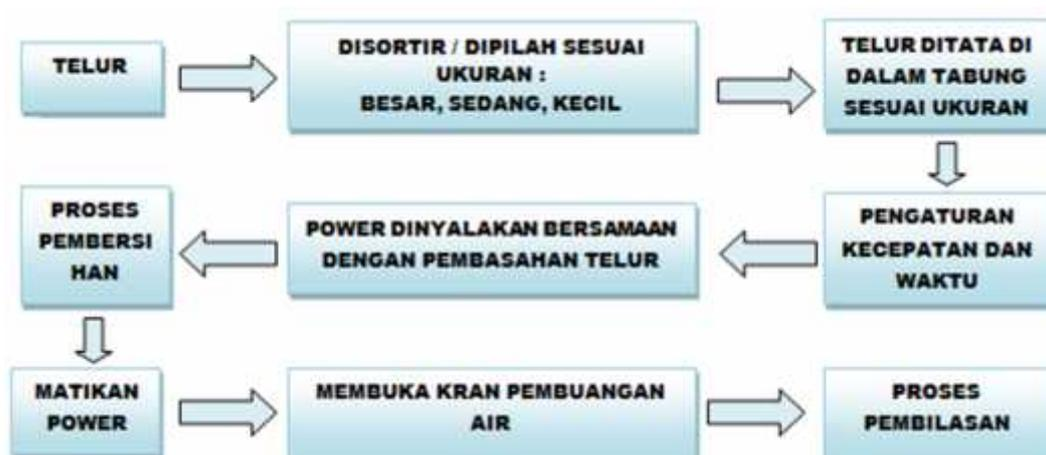
**Gambar 12.** Prinsip kerja Mesin Pencuci Telur
