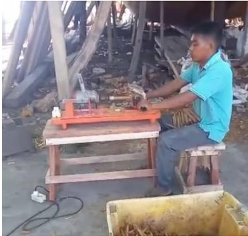
Gambar 4.2 Proses Pembentukan Pasak Setelah Perancangan
