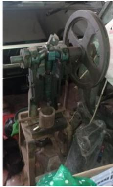
Dalam identifikasi kedua mesin *punch* manual yang saat ini di gunakan untuk proses pelubangan dan pemotongan ujung pegangan rantang soto memiliki keterkaitan akan proses penyelesaian pegangan rantang soto yaitu proses mesin ke mesin berurutan setelah pelubangan dilanjutkan dengan pemotongan. *Punch* dan *dies* pada kedua mesin memiliki bentuk dan spesifikasi yang berbeda disesuaikan dengan proses kerja masing-masing seperti yang di tampilkan pada Gambar 3:
