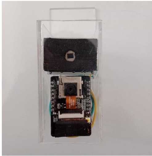
Gambar 3. Rangkaian Kamera Portabel
