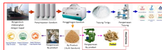
Gambar 1. Alur proses produksi terigu di bogasari
