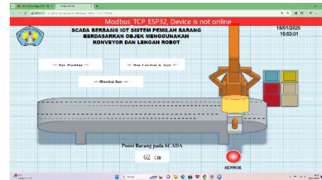
Gambar 16. Hasil Pengujian Posisi 3 Tabung Kuning pada Tampilan Scada
