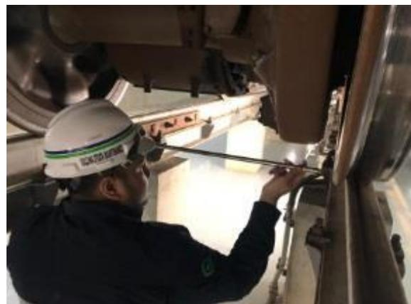
Gambar 9. Proses pengukuran jarak menggunakan alat yang dibuat pada *axle* kereta
