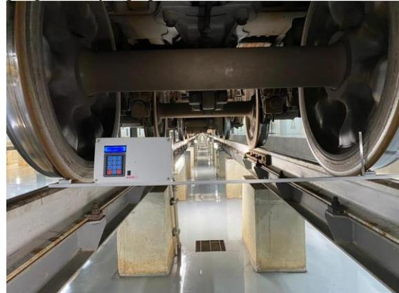
Gambar 8. Menempatkan alat saat pengukuran pada *axle* kereta
